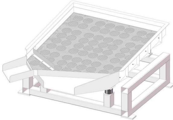
震动筛框双层分隔，配优质橡胶弹簧和震动电机，筛分顺畅充分。
