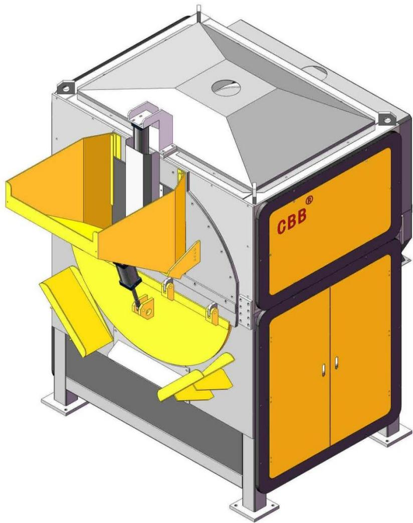
滚筒清砂机由钢板、型材焊接而成，内部均布有螺旋叶片，配有自动闸门和自动舱门，进出料控制方便。滚筒外部设计全封闭钣金密封，并有消音及除尘管道连接设计，环保。
